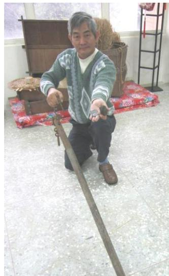
圖四：秤豬的桿秤，須用兩人扛秤的吊環。
