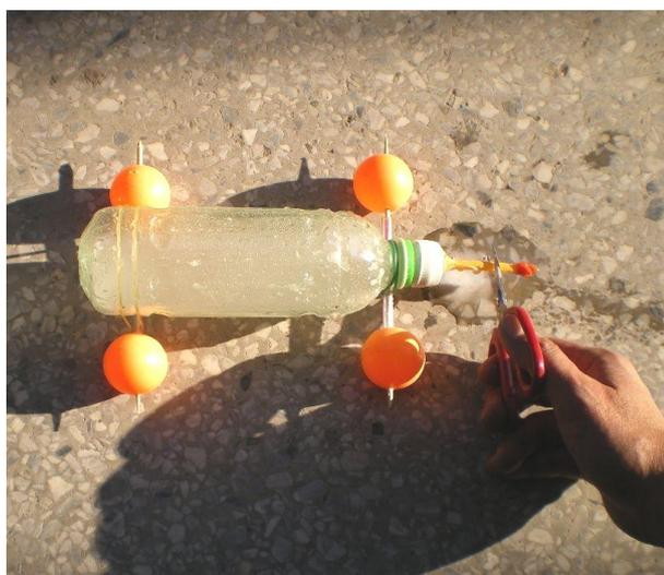
照片三：水量、醋與小蘇打都要多，產生的氣壓就會愈高，推力愈強。又站立發射時，瓶的仰角約 30 度才能射得最遠。本活動藉著氣體的壓力把水排出，也算是一種排水集氣法。
