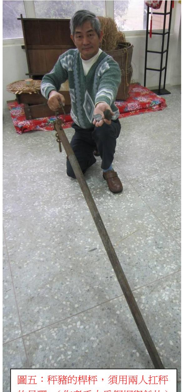
圖五：秤豬的桿秤，須用兩人扛秤的吊環。（作者手中爲銅帽與鉛片）
