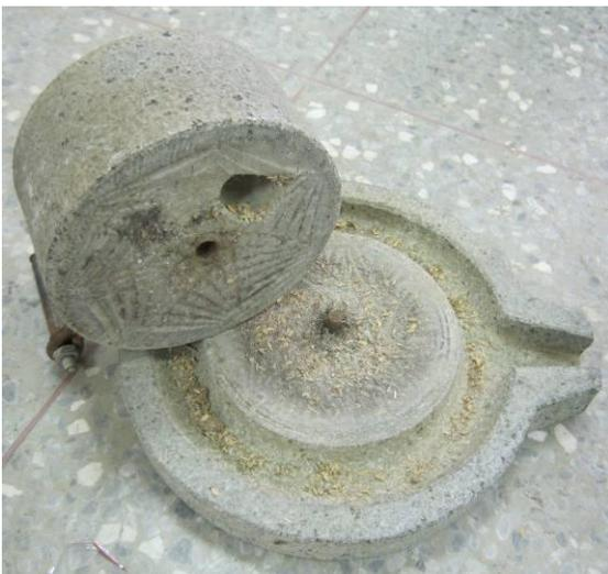
圖三：石磨，能將米粒磨成粉。
